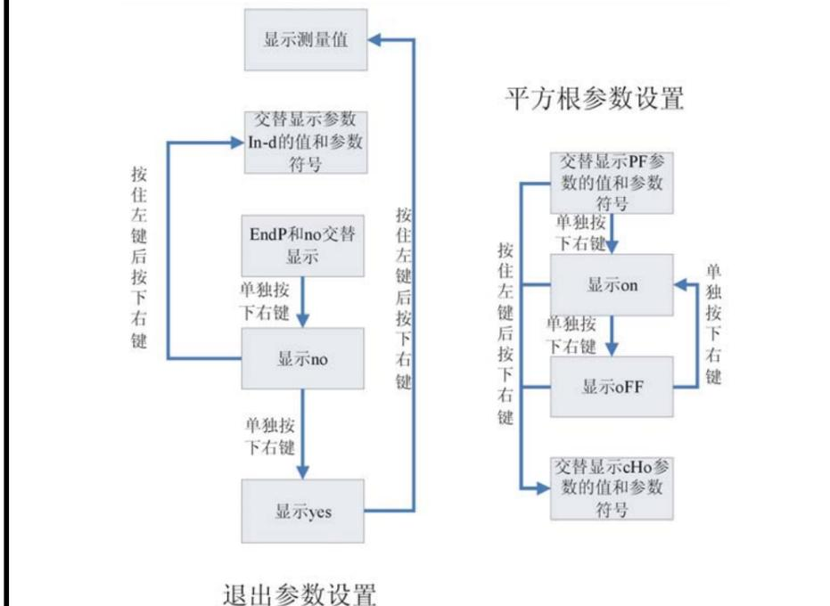
图2: 左边图解说明如何退出参数设置及误进入退出选项后如何回到参数设置,右边图解说明如何进行 PF 参数的设置。
