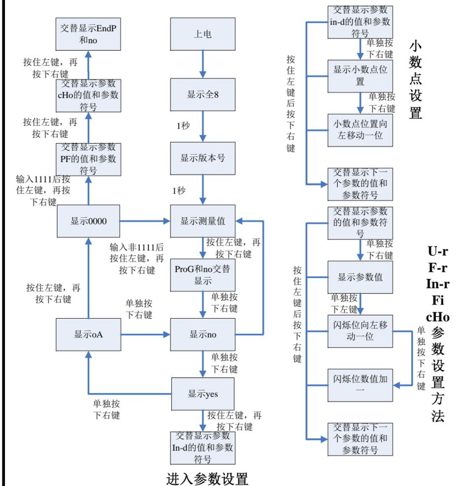
图1: 左边图解说明如何从测量状态进入参数设置状态及误进入后如何退出,右边图解说明 U-r, F-r 等参数值为数字的参数的设置方法。
